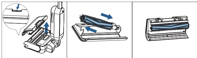
**注意:毛刷滚筒电机最大打开角度约45°,请谨慎操作。**
