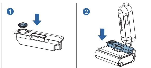
**注意:**1. 为了防止安装不当导致漏水，请确保污水箱安装到位，安装后与清洁头平齐。
