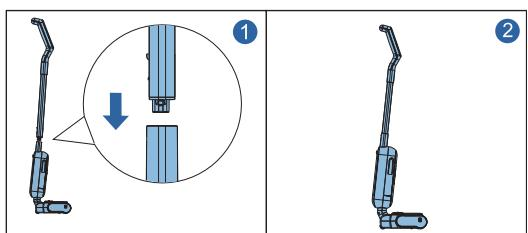
如需拆掉手柄, 请使用工具插入机身背面的卡扣孔, 解开卡扣后向上拆掉手柄。
