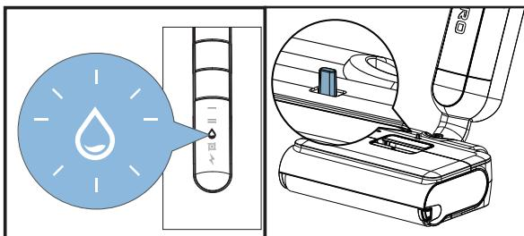
当地面有污水等液体垃圾时，污水箱可能会在换水指示灯报警前水满。当污水箱浮子露出时，请及时换水。
